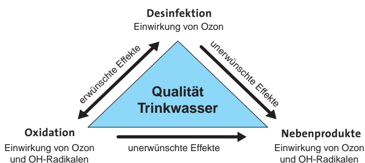
Abb. 2: Desinfektion und Oxidation sind die wichtigsten Ziele der Anwendung von Ozon. Beide Prozesse werden von der Bildung unerwünschter Nebenprodukte begleitet.
